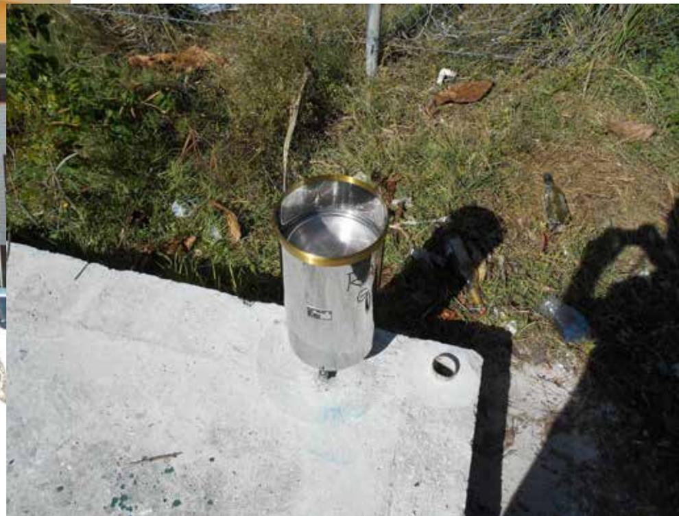
USPに設置してある雨量計. 0.5mm単位の観測で、HOBO eventデータロガーにカウント時刻を記録している.
