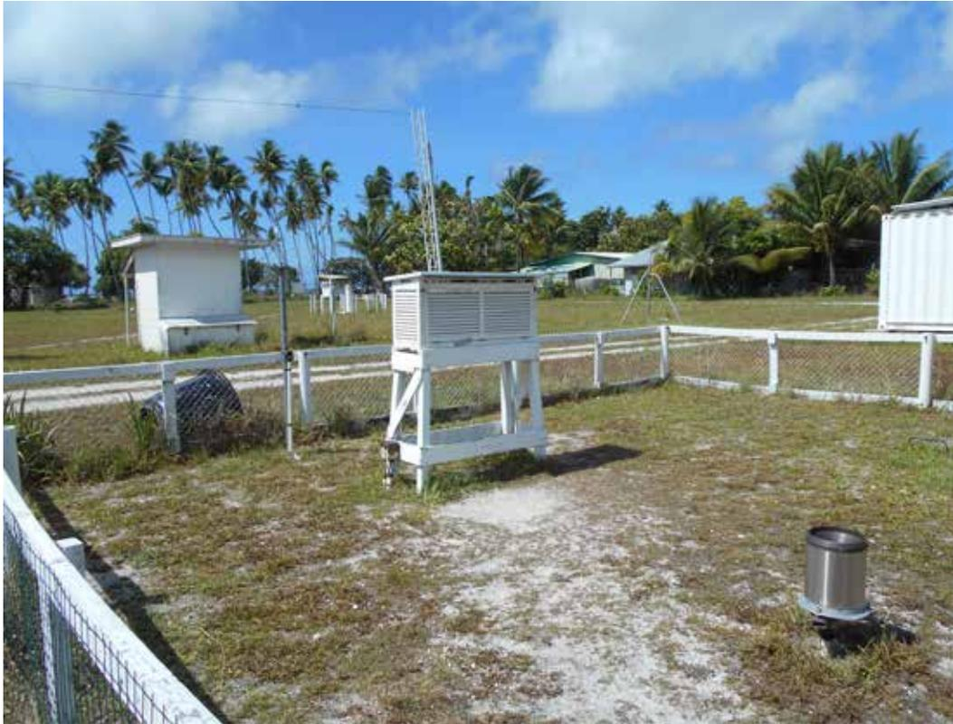
Betio気象観測所における最高最低温度計が収納されている百葉箱。風向風速・降水量は自動観測されている。
