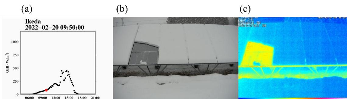
図 2：2022 年 2 月 20 日 9 時 50 分の太陽光発電システム上の積雪のモニタリング事例。(a) 日射量観測値、(b)可視画像、(c) 赤外画像をそれぞれ示す。
